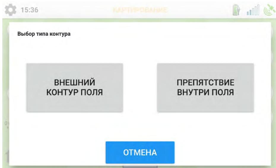
На экране отобразится красный маркер начала контура. После завершения объезда поля и приближении к маркеру на 3 метра запись контура завершается автоматически. Также контур можно замкнуть в любой момент по нажатию на центральную кнопку. Контур поля отображается оранжевым цветом.
