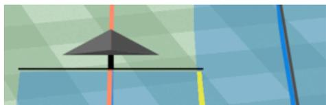
В процессе работы на карте отображаются трек и обработанная область, закрашенная синим цветом. Перекрытия обработанной области закрашиваются желтым цветом.
