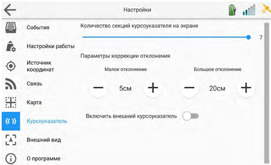
«Включить внешний курсоуказатель» - включение/выключение светодиодной полосы
