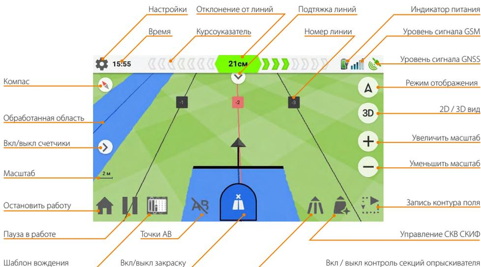
В центре экрана отображается навигационный курсор со схематическим изображением орудия. Координаты, получаемые от навигационного приемника, соответствуют красной точке на картинке.
