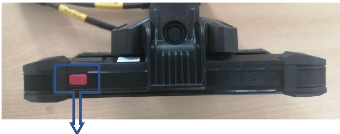
Кнопка включения терминала
