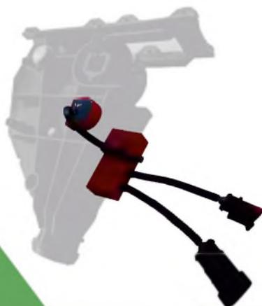
**Датчик ДС предназначен для контроля пролета (посевного материала и удобрений) к сошнику через семяпровод в составе механической сеялки. Устанавливается в разрыв семяпровода совместно с соединительным патрубком.**
