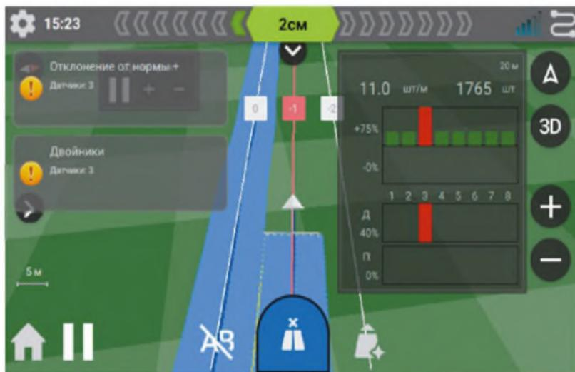
Интеграция системы ГлоНАШ и системы СКИФ позволяет визуализировать показания датчиков непосредственно на дисплее ГлоНАШ в режиме навигации по полю. То есть на экране одновременно показываются направляющие линии АВ, смещение трактора и сеялки, скорость, обработанная площадь, а также вся информация со СКИФа.
